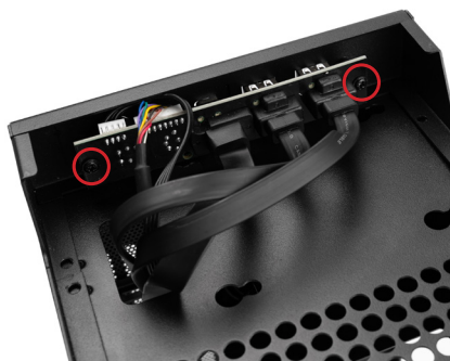
更换脚架，并固定好 IO 模块
