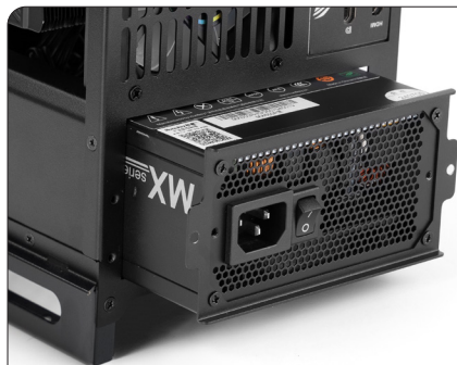
将接好线的电源放入机箱
