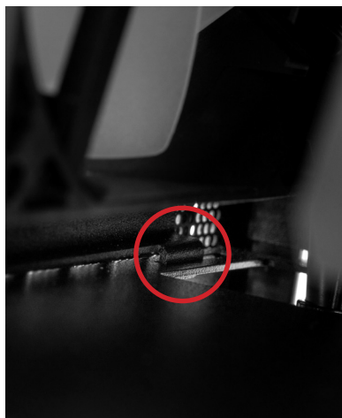
确认支架底部卡住孔位
