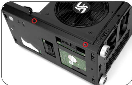
安装小侧板跟脚垫
