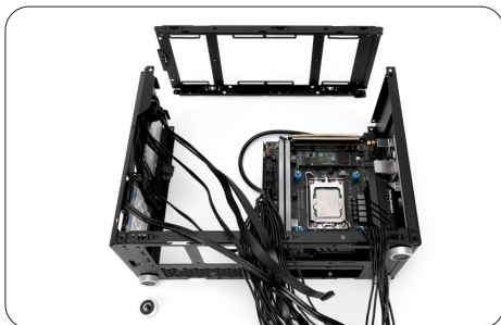
拆下顶部框架以及开关底下的脚垫
