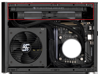
水冷方案极限厚度 60mm
