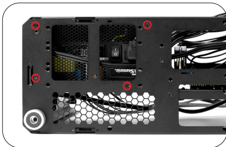
① ATX 电源孔位
