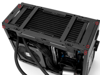
固定好顶部框架
