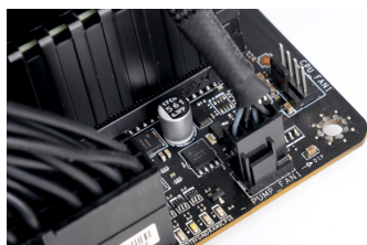
PUMP FAN 冷头水泵供电线接口
