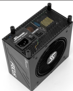
将增高螺柱拧在电源上
