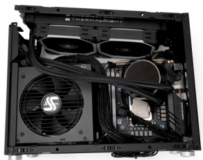
冷排放入机箱，调整好水管位置
