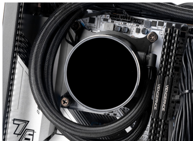
调整好水管位置 插好水冷头电源，固定好水冷头
