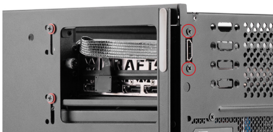
安装 HDMI 延长线 （用 2.5 寸硬盘 M3 沉头螺丝固定）
