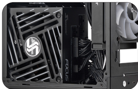
接上所有的电源供电线，包 括显卡供电线，并适当整理
