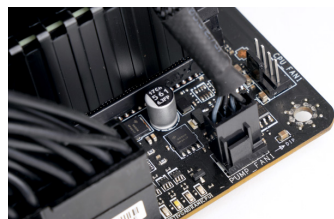
PUMP FAN 冷头水泵供电线接口
