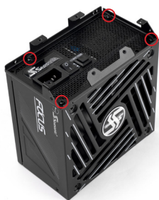
支架斜面对着电源风扇这边固定
