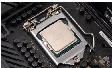
请装好散热器扣具再整体装机
