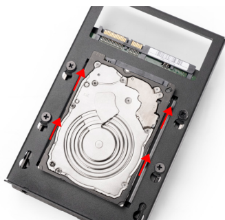
将拓展硬盘支架向下按压再平推固定 (注意硬盘金手指朝向硬盘架开口方向)
