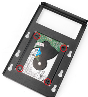
将 2.5 寸硬盘固定在侧装硬盘支架上 (注意硬盘金手指朝向硬盘架开口方向)
