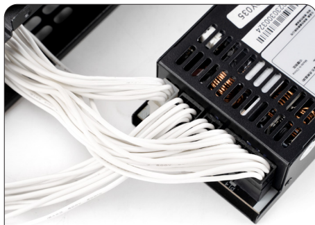
接上所有的电源供电线 包括显卡供电线，适当整理
