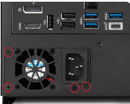
将接好线的电源放入机箱固定
