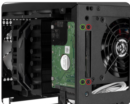
2.5 寸硬盘孔位 (7mm 厚以内 *2 个或 15mm 厚以内 *1 个)
