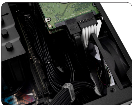
接上所有的电源供电线 包括显卡供电线，适当整理
