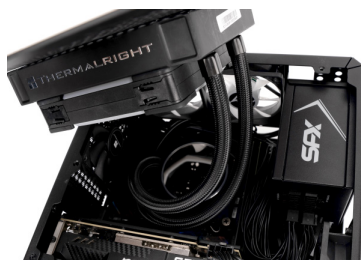
冷排放入机箱，水管盘旋在冷头上方
