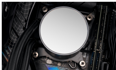
插好水冷头电源，固定好水冷头
