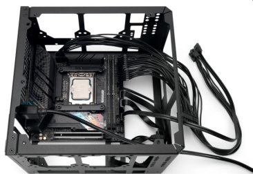
请装好散热器扣具再整体装机
