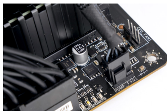
PUMP FAN 冷头水泵供电线接口
