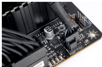
PUMP FAN 冷头水泵供电线接口
