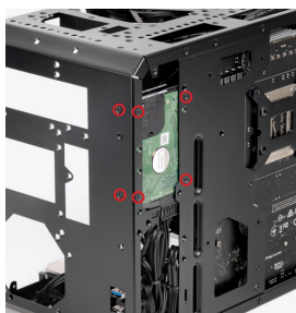
风冷方案： 2.5 寸硬盘位 (7mm 厚以内 *2 个或 7mm 厚以上 *1 个) 2.5 寸硬盘
