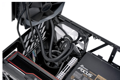
冷排放入机箱，水管盘旋在冷头上方
