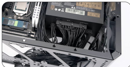
接上所有的电源供电线 包括显卡供电线，适当整理
