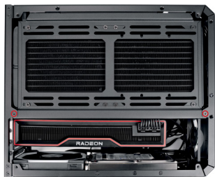
将支架固定在机箱上
