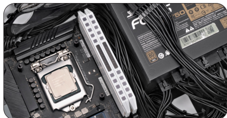
内存条安装 内存条中间对对准防呆卡口，确定卡扣回弹
