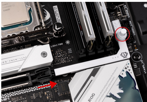
按下显卡卡扣或者按住显卡的锁扣使之后退（松开按键会自动复位）
