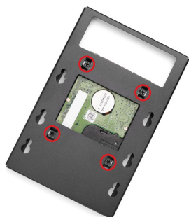
将 2.5 寸硬盘固定在侧装硬盘支架上 (注意硬盘金手指朝向硬盘架开口方向)
