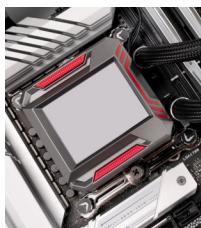
插好水冷头电源 固定好水冷头
