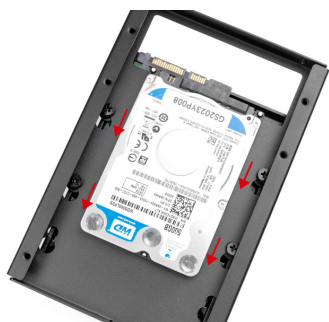
将拓展硬盘支架向下按压再平推固定 (注意硬盘手指朝向硬盘架开口方向)
