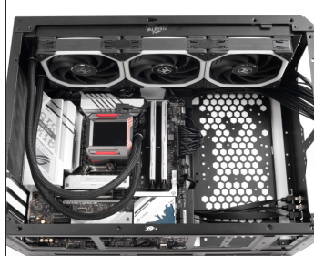
插好水冷头电源 固定好水冷头
