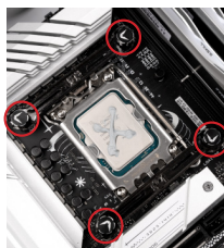
涂硅脂、安装扣具 硅脂不宜过多
