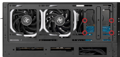
3.5 寸硬盘孔位图 (将占用底部风扇位)
