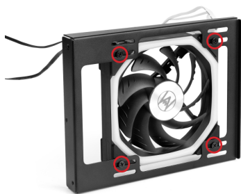
将 12CM/14CM 风扇固定在内存风扇支架上 (注意风扇进出风方向)
