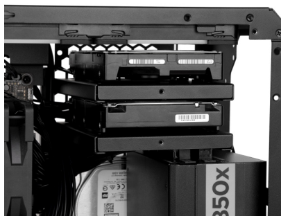
可根据电源长度决定安装的数量和位置
