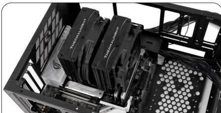
风冷请装好主板模块 再整体装入机箱会更方便操作
