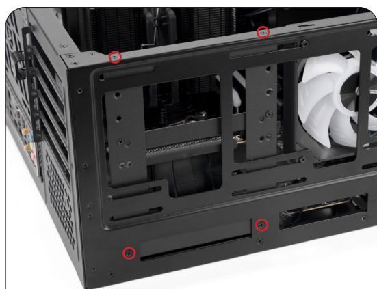
底板固定在机箱上孔位图
