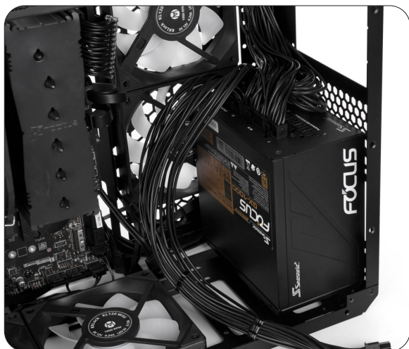
接好线材 包括显卡线 + 一根 8PIN 显卡供电线，并适当整理
