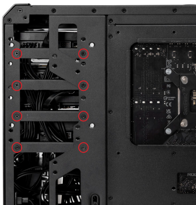
在机箱背面固定硬盘支架
