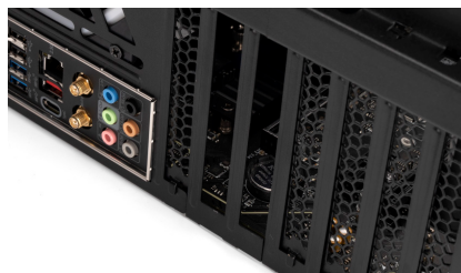
拆下显卡防尘挡板
