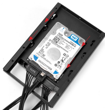
将拓展硬盘支架平推固定 (注意硬盘金手指朝向硬盘架开口方向)
