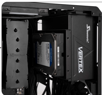
将拓展硬盘支架平推固定 (注意硬盘金手指朝向硬盘架开口方向)
