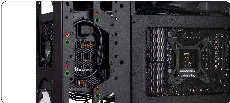
280 水冷方案电源孔位 (两档可调)
