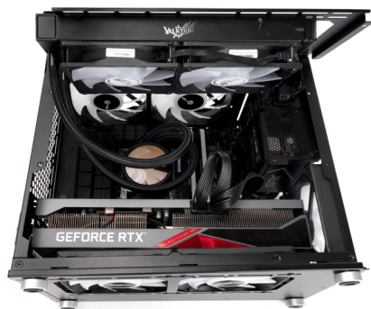
冷排放入机箱，水管盘旋在冷头上方
