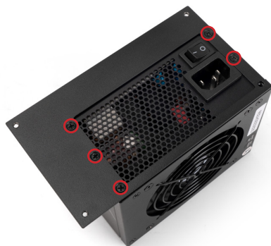
SFX/SFX-L 电源转接板孔位
